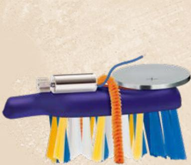
**5** Mach' dem Roboter Beine: Lege zwei Pfeifenreiniger zwischen Motor und Batterie, einer sollte ganz nah an der Batterie liegen. Biege sie so um, dass sie den Boden berühren.
